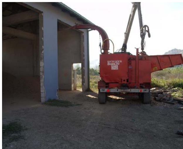
Stroj za pripremu sječke u krugu JKP „9. septembar“ Srebrenik
